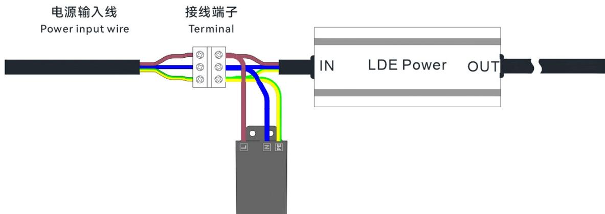
注：1、SPD 的 PE 线应与整机的接地端子连接。
