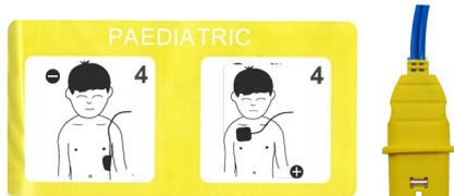
Los electrodos pediátricos con el conector amarillo son para niños con un peso inferior a 25 kg (menores de 8 años). El dispositivo distingue automáticamente los electrodos de adulto de los pediátricos. El ajuste de energía se reduce automáticamente cuando se conectan los electrodos pediátricos.
