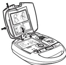
Fare scorrere il cavo lungo le tre guide sulla parte posteriore dello sportello (indicate dalle frecce nell'immagine).
